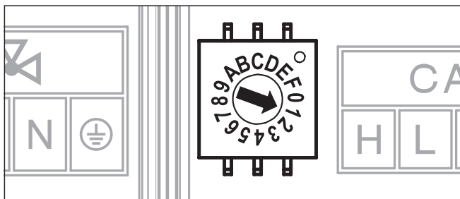
Bild 22-1 Einstellung Geräteerkennung für Mischermodule EHS157068
