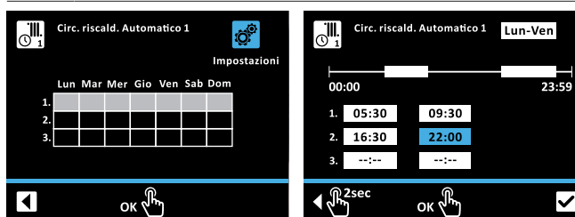
Fig. 55-9 Funzione Progr. Orario con livello d'insieme (sinistra) e livello di impostazione (destra)
