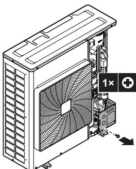
3 Ako je potrebno, uklonite stražnju ploču uvoda cijevi. To je npr. potrebno u sljedećim slučajevima:
