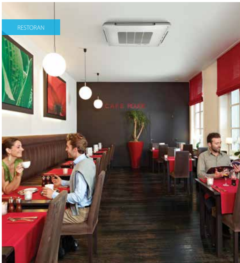
Podstropna jedinica FXUQ-A: Jedinstveni Daikin uređaj za velike prostorije bez spuštenih stropova i bez slobodnog prostora na podu
