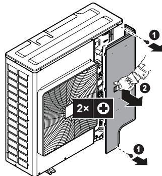
**2** Ako je potrebno, uklonite prednju ploču uvoda cijevi. To je npr. potrebno u sljedećim slučajevima:
